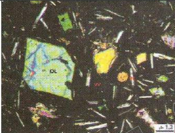
الوثيقة (13): صورة لشريحة بازلت تحت المجهر المستقطب
